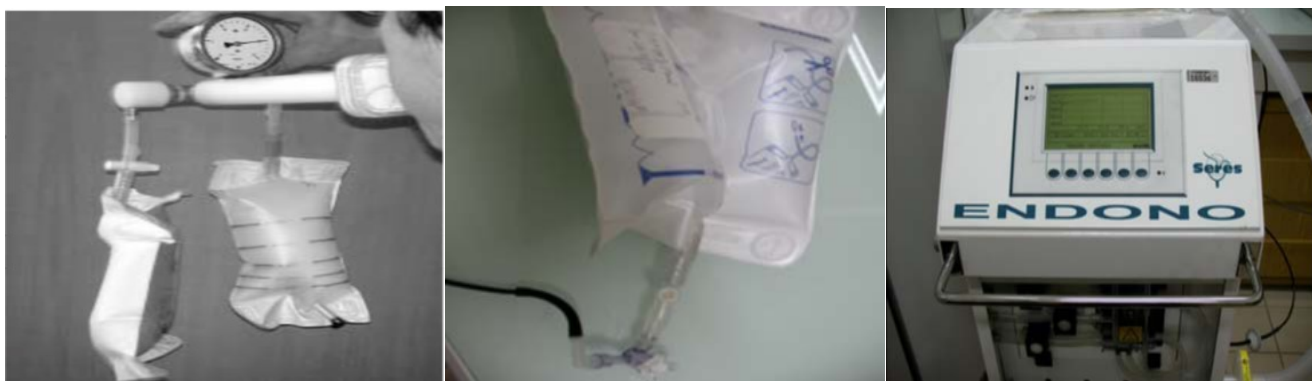
FIGURE 1. Matériels pour la mesure du NO expiré. a) Système de recueil des gaz expirés. b) Sac de recueil. c) Appareil
